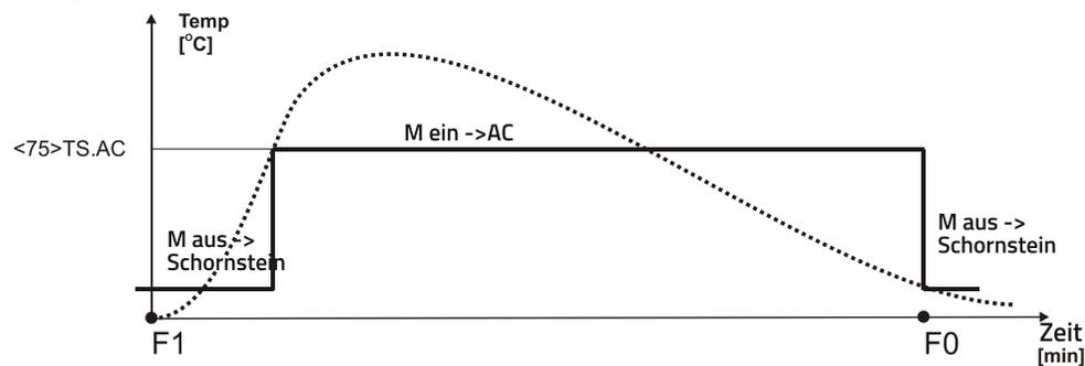
Im Ruhestand ist der Ausgang **M.AC** ausgeschaltet. Die Klappe ist auf den Schornstein gerichtet. Nach Beendigung der Anheizphase **F2** und Erreichen der eingestellten Temperatur  $<75> TS.AC$  wird die Klappe eingeschaltet und die Abgase zu **AC** geleitet. Nach Beendigung der Verbrennung wird **M.AC** ausgeschaltet. Die Klappe ist wieder auf den Schornstein gerichtet.
