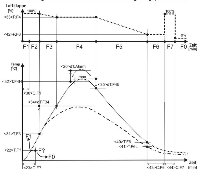
! Die folgende Konvention der Parameterbestimmung <22> T.F? = 45 °C wurde angenommen, was bedeutet, dass der mit "T.F?" (Neustarttemperatur nach dem Einschalten) angegebene Parameter Nr. <22> auf 45 ° C eingestellt ist.
