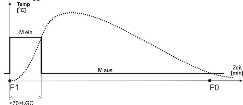
Der Schornsteinzuggenerator ist an den Ausgang **M.GC** angeschlossen. Der Generator schaltet sich ein, wenn die Ofentür geöffnet wird (Türkontaktschalter erforderlich), und schaltet sich nach **<70> tGC = 1 Minute** seit dem Schließen der Tür aus.
