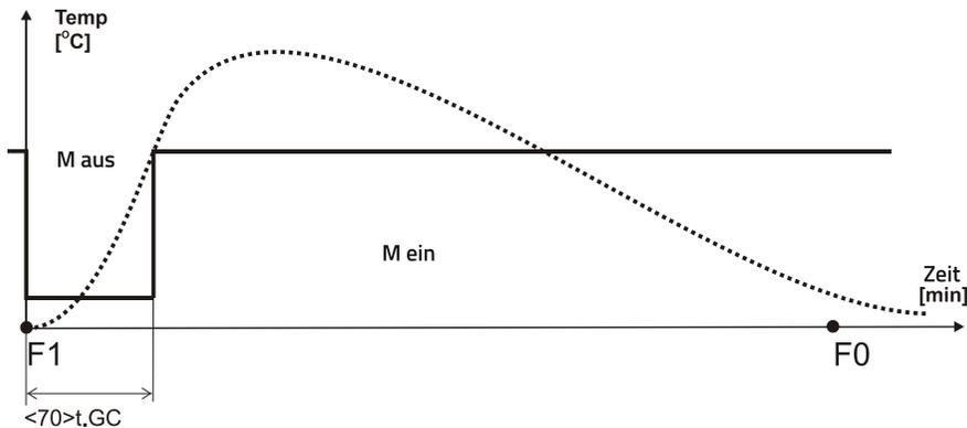
Eine Dunstabzugshaube oder eine mechanische Lüftung ist an den Ausgang **M.GC** angeschlossen. Die Belüftung wird nach dem Öffnen der Ofentür abgeschaltet. Dadurch wird verhindert, dass die Abgase in den Raum gezogen werden. (Türkontaktschalter erforderlich). Die Belüftung wird nach **<70> tGC = 1 Minute** seit dem Schließen der Tür wieder angeschaltet..
